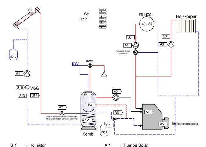
= Kombi Unten S 2 S 3 = Kombi Mitte S 4 = Kombi Oben S 7 = 3 Wege umschalt (Rückl FBH) = Vorlauf FBH S 8 S 9 = Vorlauf Heizkörper = Kessel an der Heizung S 10 S 12 = Aussentemperatur
