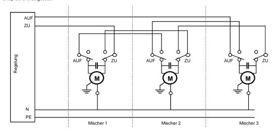
Sowohl der Hydraulikplan als auch der Verdrahtungsplan geben die Situation bei der Verwendung von drei Mischern wieder. Selbstverständlich kann man die Pläne an weniger oder mehr Mischer anpassen. Man lasse einfach den Mischer 2 weg oder füge einen oder mehrere Mischer zusätzlich ein.
