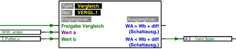
schaltet das Ventil nach Temp. Differenz um
