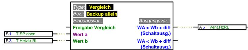
Wenn T-RL größer als Puffer oben wird RL direkt zu Backup geführt
